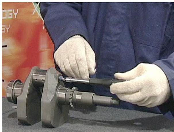
Diamètre axe de palier côté distribution
