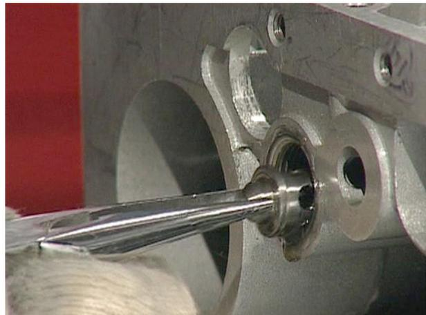
**4.13.8. MONTAGE DE LA SOUPAPE DE REGLAGE DE
