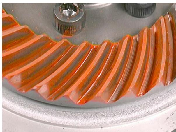
Monter le groupe couronne-pivot percé couvercle et les entretoises et joints sur le carter; visser provisoirement les vis.
