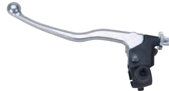
COD. 3080.04 Sinistro - Left Yamaha fulcro leva - lever fulcrum mm 32
