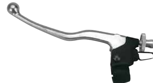
COD. 3103.04 Sinistro con regolazione rapida Left with quick adjustment fulcro leva - lever fulcrum mm 32
