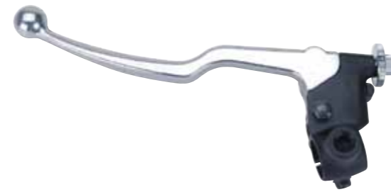
COD. 3007.04 Sinistro - Left Suzuki fulcro leva - lever fulcrum mm 31,5
