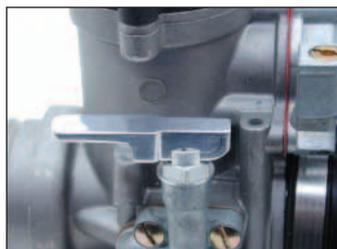
**Klappchoke - Chokebetätigung direkt am Vergaser!**
