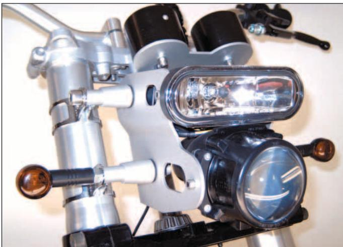
**Analoger Tachometer** im 80mm Einbaugehäuse, 60mm tief, elektronisch mit Schrittmotorantrieb. Wegimpulszahl programmierbar, Alugehäuse poliert oder schwarz eloxiert. Digitalanzeige:
