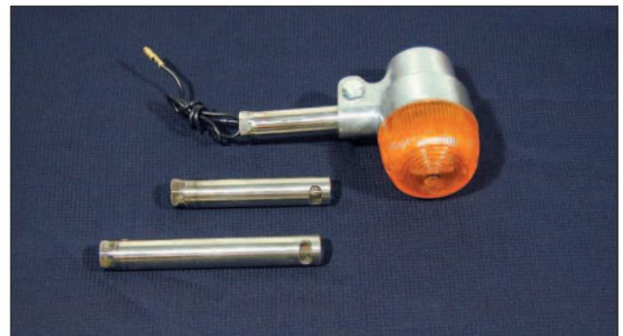
Blinker mit Haken für die Befestigung:
