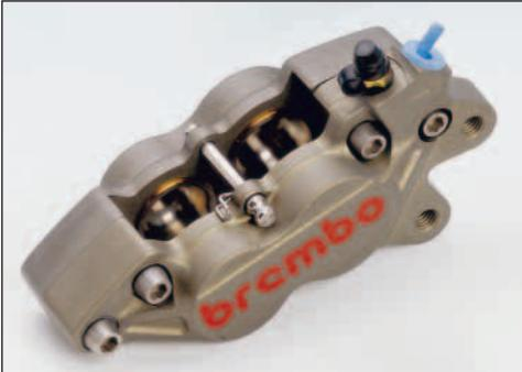
**Vierkolbenbremszange Superbike P4 32/36A gefräst, Schrauben und Kolben aus Titan, Gewicht 675gr., Lieferung ohne Bremsbeläge.**
