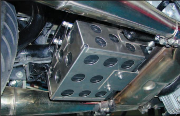
**Batteriekasten aus Edelstahl** für die gr. Guzzi-Modelle.
