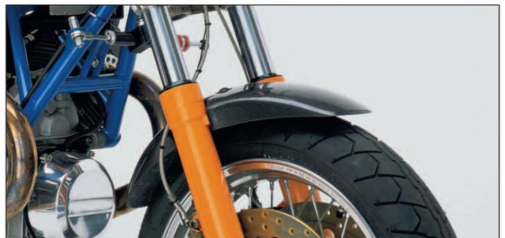
In kleinen Serien werden die abgebildeten Carbonteile in aufwendiger Handarbeit gefertigt. Die transparente Oberfläche wird auf Hochglanz poliert und bringt die Gewebestruktur hervorragend zur Geltung.
