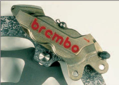
**Vierkolbenbremszange Racing Monoblock P4 32/36 CNC, Schrauben und Kolben aus Titan, Gewicht 660gr., Lieferung ohne Bremsbeläge.**
