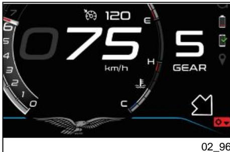
Beim Runterschalten tritt es nur in Funktion, wenn alle notwendigen Bedingungen erfüllt sind, u. A. muss die Drehzahl unter einer Höchstschwelle liegen, die je nach Gang wechselt. Wenn das System zum Herunterschalten zeitweise aus jeglichen Gründen nicht verfügbar ist (zum Beispiel RPM zu hoch, erster Gang eingelegt), erscheint das System am Armaturenbrett in orange.
