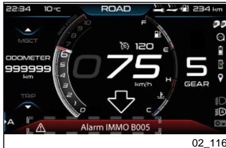
Das modulierte Signal ist das "Passwort", mit dem die Zündelektronik den Schlüssel erkennt und nur dann das Starten des Motors freigibt.
