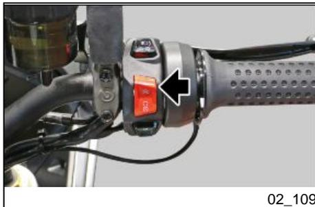
Erfüllt die Funktion eines Sicherheits- oder Not-Aus-Schalters.
