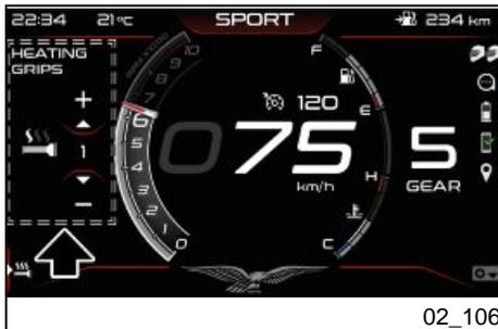
Die Aktivierung, die Deaktivierung und die Einstellung Heizstufe der Heizgriffe wird mit den Bedientasten vorgenommen.
