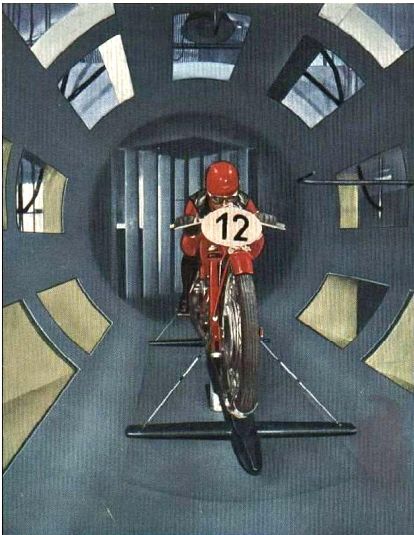
Per lo studio della forma delle macchine da corsa e della posizione del corridore e per la prova sulla aerodinamicità delle moto, è stato costruito un tunnel a vento nel quale un gruppo di ventilatori a forza centrifuga, azionati da un motore a benzina di 800 HP, aspirano aria provocando un vento della velocità di circa 160 Km. ora. Il complesso è costituito da una galleria in cemento armato, lunga 40 metri.
