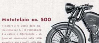
Tipo W. Allestimento mm. 88 - corsa mm. 82 - cilindrata cm. 499 - testa del cilindro smontabile - valvole ambedue in testa - inclinazione - cambio a quattro velocità comandato a pedale - frizione a dischi metallici - accensione a magnete - catena 5/8 X 1/4 - gomme Pirelli - anteriore 3.50-19 - posteriore 3.50-19 - serbatoio benzina litri 12, olio litri 2,5 - freni ad espansione sulle due ruote - velocità km. 120 - il telaio è sospeso elasticamente anche posteriormente, col sistema brevettato Moto Guzzi che assicura una incomparabile dolcezza di marcia anche su strade a fondo irregolare.
