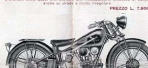
Tipo G. T. V. Allestimento mm. 88 - corsa mm. 82 - cilindrata cm. 499 - testa del cilindro smontabile - valvole ambedue in testa - inclinazione - cambio a quattro velocità comandato a pedale - frizione a dischi metallici - accensione a magnete - catena 5/8 X 1/4 - gomme Pirelli - anteriore 3.50-19 - posteriore 3.50-19 - serbatoio benzina litri 12, olio litri 2,5 - freni ad espansione sulle due ruote - velocità km. 120 - il telaio è sospeso elasticamente anche posteriormente, col sistema brevettato Moto Guzzi che assicura una incomparabile dolcezza di marcia anche su strade a fondo irregolare.
