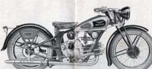
Tipo V. Allestimento mm. 88 - corsa mm. 82 - cilindrata cm. 499 - testa del cilindro smontabile - valvole ambedue in testa - inclinazione - cambio a quattro velocità comandato a pedale - frizione a dischi metallici - accensione a magnete - catena 5/8 X 1/4 - gomme Pirelli - anteriore 3.50-19 - posteriore 3.50-19 - serbatoio benzina litri 12, olio litri 2,5 - freni ad espansione sulle due ruote - velocità km. 120.
