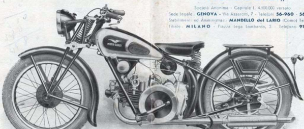
Tipo S. Alesaggio mm. 88 - corsa mm. 82 - cilindrata cm. 499 - testa del cilindro smontabile - valvole di ammissione laterale e di scarico in testa - cambio a quattro velocità comandato a mano con selettore - frizione a dischi metallici - accensione a magnete - carburatore Amal - catena 5/8 X 1/4 - gomme Pirelli 3.50-19 - serbatoio benzina litri 12, olio litri 2,5 - freni ad espansione sulle due ruote - velocità km. 120 - cambio a mano a pedale.
