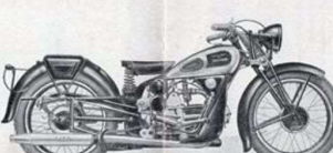
Tipo G. T. V. Allestimento mm. 88 - corsa mm. 82 - cilindrata cm. 499 - testa del cilindro smontabile - valvole ambedue in testa - inclinazione - cambio a quattro velocità comandato a pedale - frizione a dischi metallici - accensione a magnete - catena 5/8 X 1/4 - gomme Pirelli - anteriore 3.50-19 - posteriore 3.50-19 - serbatoio benzina litri 12, olio litri 2,5 - freni ad espansione sulle due ruote - velocità km. 120 - il telaio è sospeso elasticamente anche posteriormente, col sistema brevettato Moto Guzzi che assicura una incomparabile dolcezza di marcia anche su strade a fondo irregolare.
