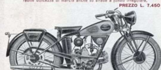
Tipo P. E. 250 Allestimento mm. 68 - corsa mm. 64 - testa del cilindro smontabile - valvole ambedue in testa - inclinazione - cambio a quattro velocità comandato a pedale - frizione a dischi metallici - accensione a magnete - catena 5/8 X 1/4 - gomme Pirelli - anteriore 3.50-19 - posteriore 3.50-19 - serbatoio benzina litri 12, olio litri 2,5 - freni ad espansione sulle due ruote - velocità km. 105.
