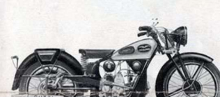
Tipo P. E. 250 Allestimento mm. 68 - corsa mm. 64 - testa del cilindro smontabile - valvole ambedue in testa - inclinazione - cambio a quattro velocità comandato a pedale - frizione a dischi metallici - accensione a magnete - catena 5/8 X 1/4 - gomme Pirelli - anteriore 3.50-19 - posteriore 3.50-19 - serbatoio benzina litri 12, olio litri 2,5 - freni ad espansione sulle due ruote - velocità km. 105.
