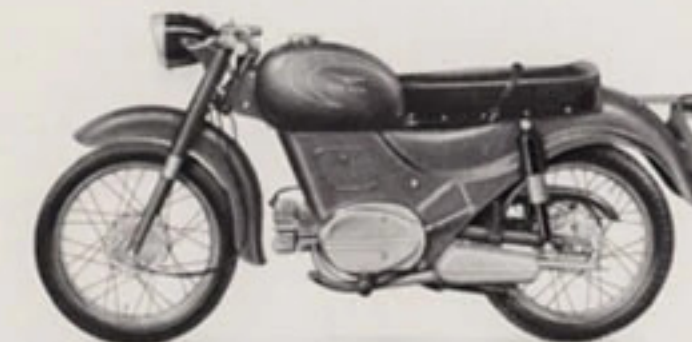
Modello/Anno: Zigolo 110cc / 1960 Motore: Due Tempi Monocilindrico Orizzontale 52 x 52mm /110cc Potenza: 4 CV a 5200 Giri/Min Peso: 75 Kg Velocità Massima: 50 KM/h
