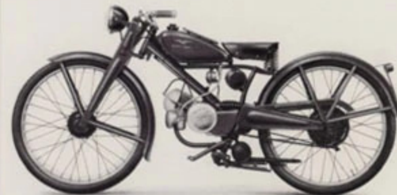
Modello/Anno: Motoleggera 65 / 1946 Motore: Due Tempi Monocilindrico Inclinato 42 x 46mm /64cc Potenza: 2 CV a 5000 Giri/Min Peso: 45 Kg Velocità Massima: 50 KM/h
