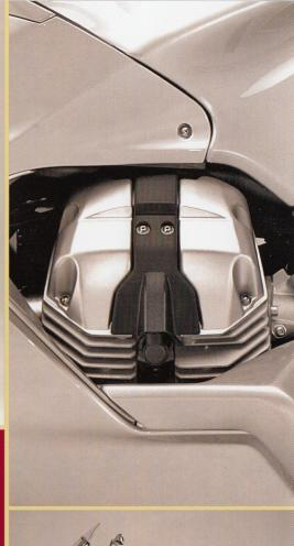
**ENGINE TYPE** 90° V-Twin, 4 stroke
