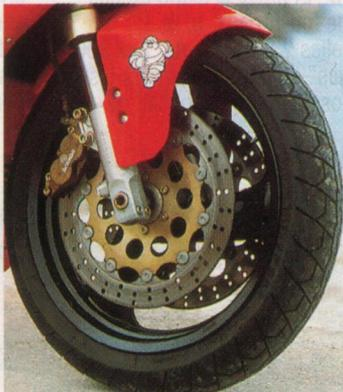
Le double disque Ø 320 mm pincé par des étriers Brembo quatre pistons se montre très puissant et efficace.
