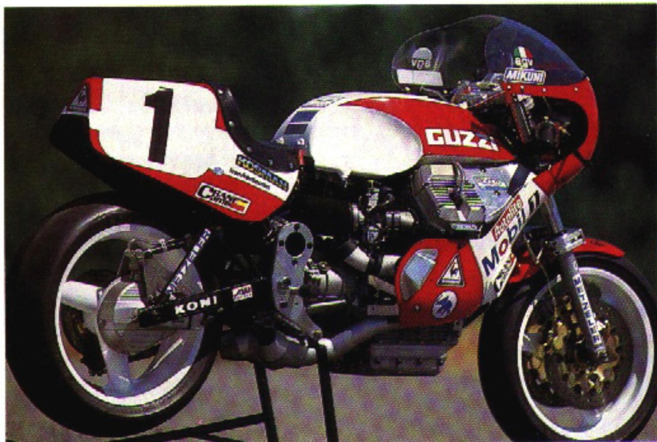
**La Guzzi très spéciale de Docteur John a servi à développer et mettre au point la future Guzzi 4 soupapes de série. Construite sans vraiment se soucier du poids, la Guzzi ne pèse que 158 kg, ce qui contredit l'apparente impression de lourdeur. La suspension arrière est un Cantilever doublé d'un parallélogramme qui contrôle le mouvement du pont. L'arbre de transmission travaille à l'air libre.**
