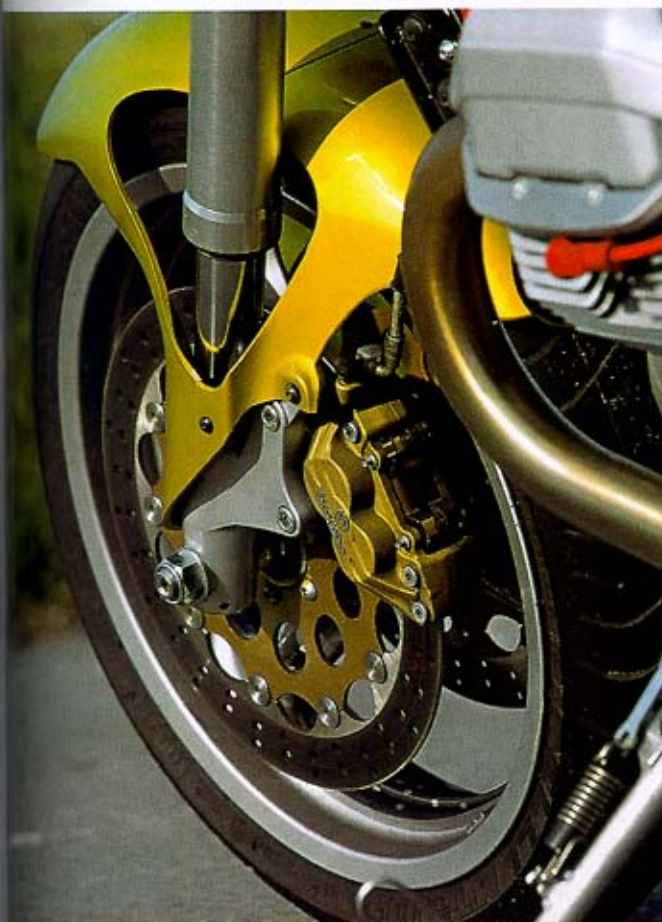
Le double-disque flottant de 320 mm, pincé par des étriers
