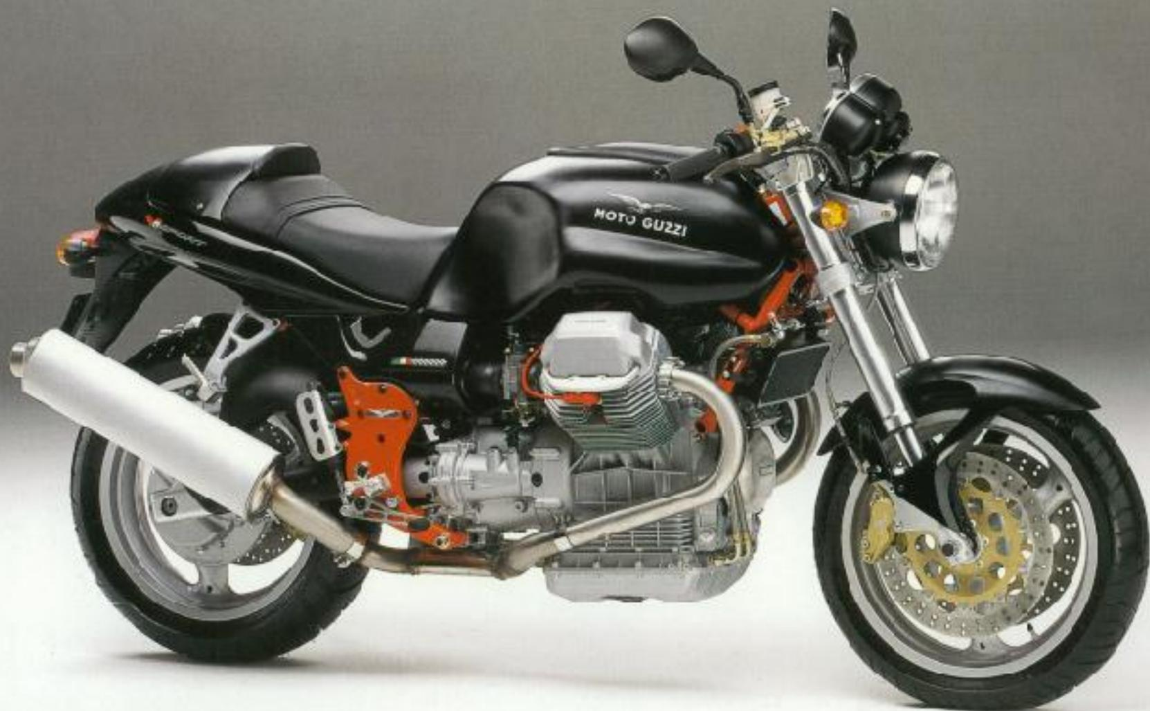
Basierend auf dem klassischen Monobloc-Stahlrahmen mit rechteckigem Querschnitt, wurde der Rahmen weiter verbessert. Der Lenkkopfwinkel, einen Grad scharfer als bei dem vorhergehenden Sport Corsa Modell (von  $26^\circ$  auf  $25^\circ$ ), macht die V11 Sport zu einem hervorragend zu handhabenden Motorrad.
