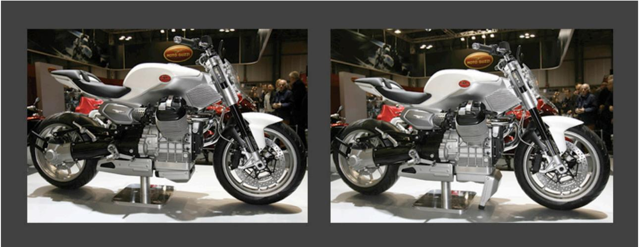
Même le V12 Route maintient une exclusivité absolue merci aux solutions cousues autour de l'à deux cylindres Mouvement Guzzi. Encore une fois ils se réalisent choisies technicien et esthétiques impossibles avec un schéma moteur traditionnel. Les estrades du passager, solidaire aux forcellone par leveraggio, semblent suspendues en conférant une image de légèreté et pulizia qui est un peu le symbole de l'entier je projette.
