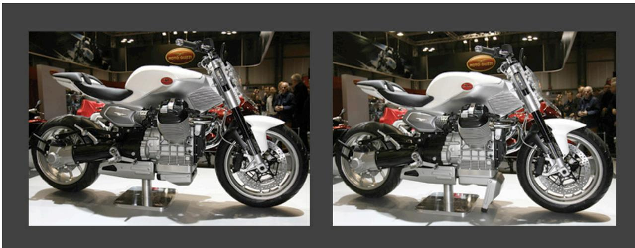
Anche la V12 Strada mantiene una esclusività assoluta grazie alle soluzioni cucite intorno al bicilindrico Moto Guzzi. Ancora una volta si realizzano scelte tecniche ed estetiche impossibili con uno schema motore tradizionale. Le pedane del passeggero, solidali al forcellone tramite leveraggio, paiono sospese conferendo una immagine di leggerezza e pulizia che è un po' il simbolo dell'intero progetto.
