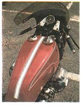
Superbe réservoir en poly de 25 litres. Pour le Bol, il était en alu. Le deuxième bouchon servait à surveiller le niveau pendant le remplissage.
