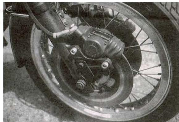
Une des rares, sinon la seule à adopter un freinage confié à des Lockheed racing. Les fourreaux spécialement conçus pour ces freins et par Guzzi sont uniques et interdisent la moindre chute.
