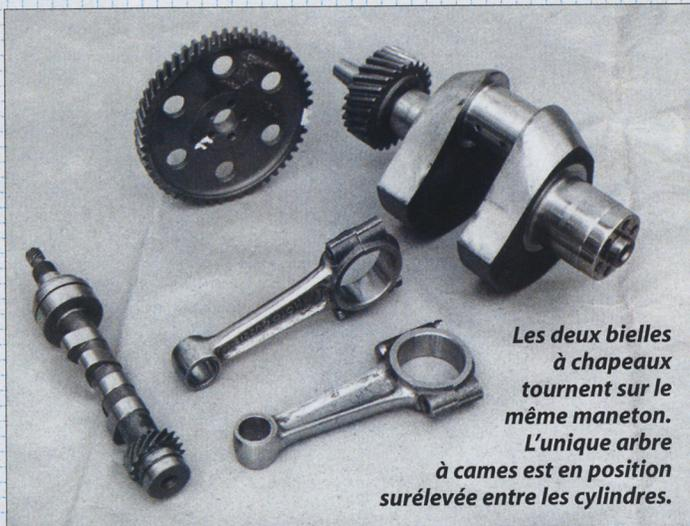
*Les deux bielles à chapeaux tournent sur le même maneton. L'unique arbre à cames est en position surélevée entre les cylindres.*
