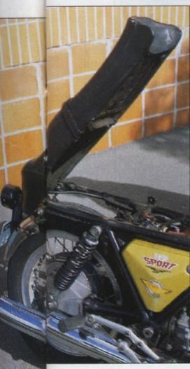
**La selle bascule pour donner accès aux fusibles tandis que le garde-boue arrière est articulé pour permettre le démontage de la roue arrière.**
