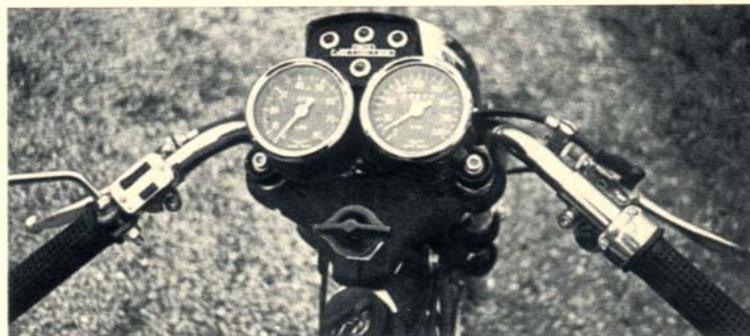
En tournant de 90° le papillon sur la colonne de direction, on embrave ou on débrave l'amortisseur de direction. Le support de la clé de contact se trouve juste derrière. La clé a quatre crans : contact coupé et direction bloquée, contact coupé et direction libre, contact mis et démarrage. Pour le démarrage, il y a également un bouton près du pouce droit. Les boîtes à outils s'ouvrent avec une autre clé.
