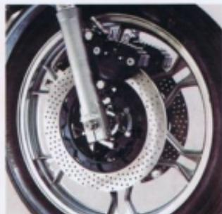
Als Hochleistungs-Motorrad, das seine Leistung auch auf die Straße bringen soll, besitzt die 850 Le Mans das entsprechend leistungsstarke Bremssystem: das patentierte Integral-Bremssystem, das alle großen Moto-Guzzis auszeichnet. Die linke Bremsscheibe vorn und die
