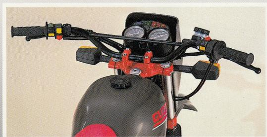
LA STRUMENTAZIONE COMPRENDE: IL CONTAGIRI, IL TACHIMETRO/CONTACHILOMETRI CON PARZIALIZZATORE E SEGNALATORI LUMINOSI VISUALIZZATI
