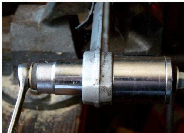
Maintenir fermement l'écrou de la douille de 22 et commencer à visser celui de la douille de 30. Il se peut qu'il faille forcer pour arriver à décoller le silent-bloc.
