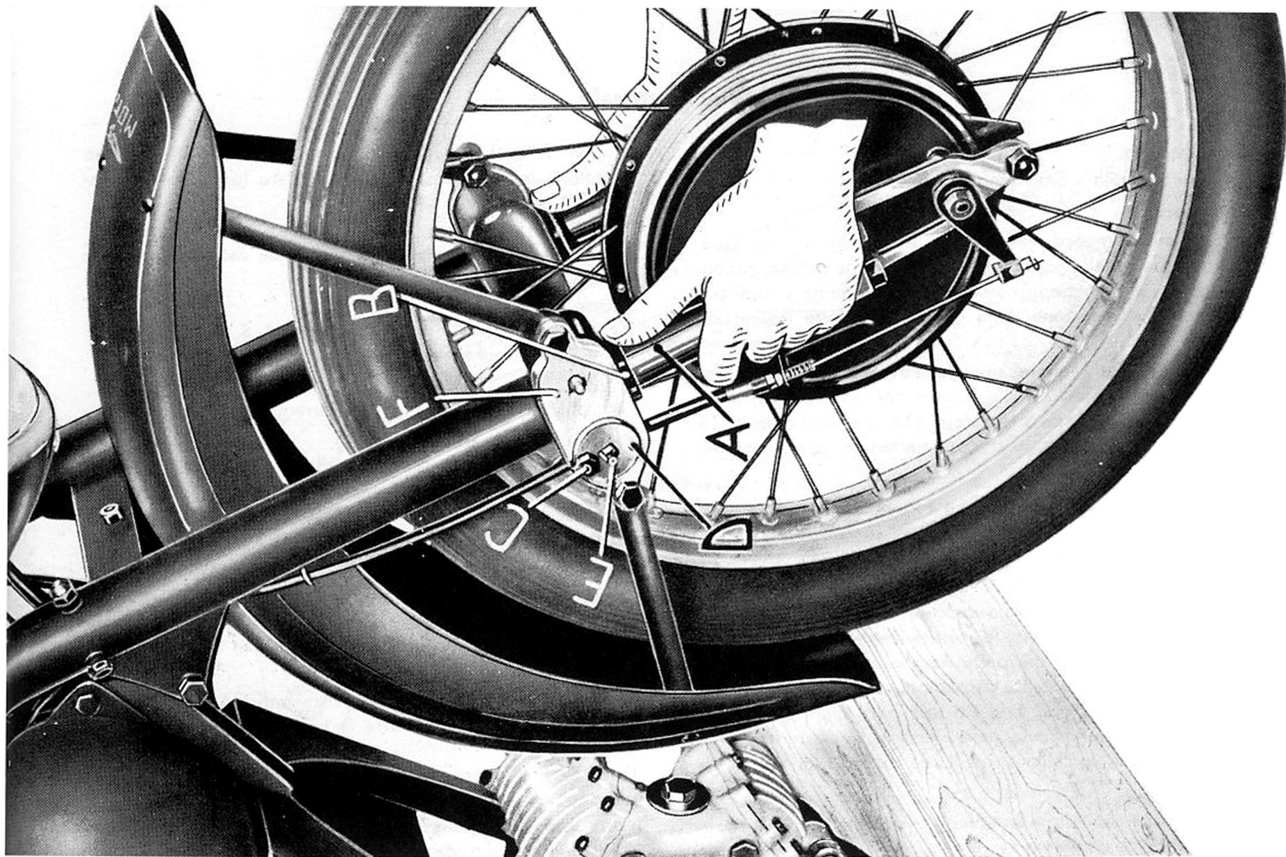
Fig. 33 - Registrazione della forcella telescopica
