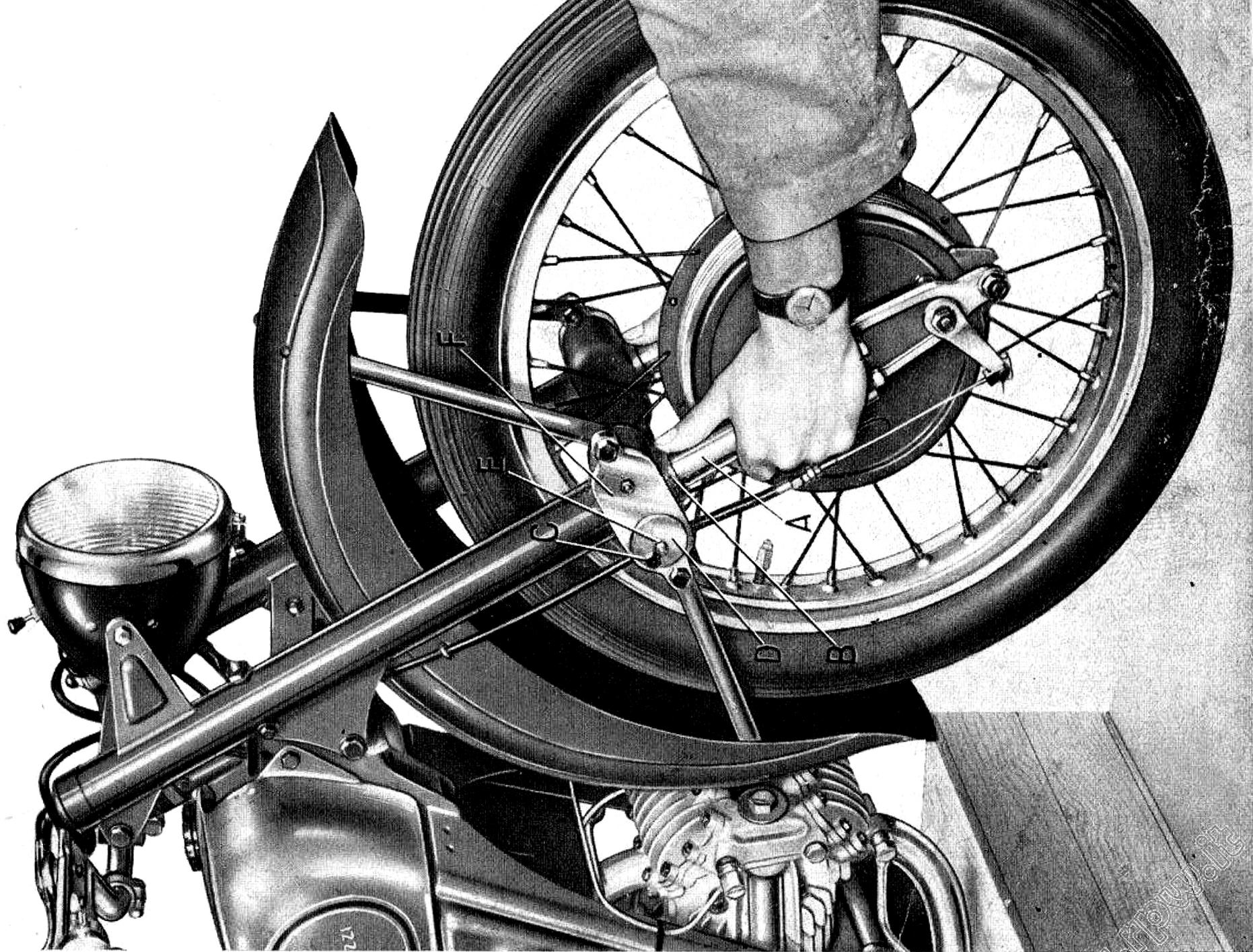
**Fig. 34 - Registrazione della forcella telescopica**
