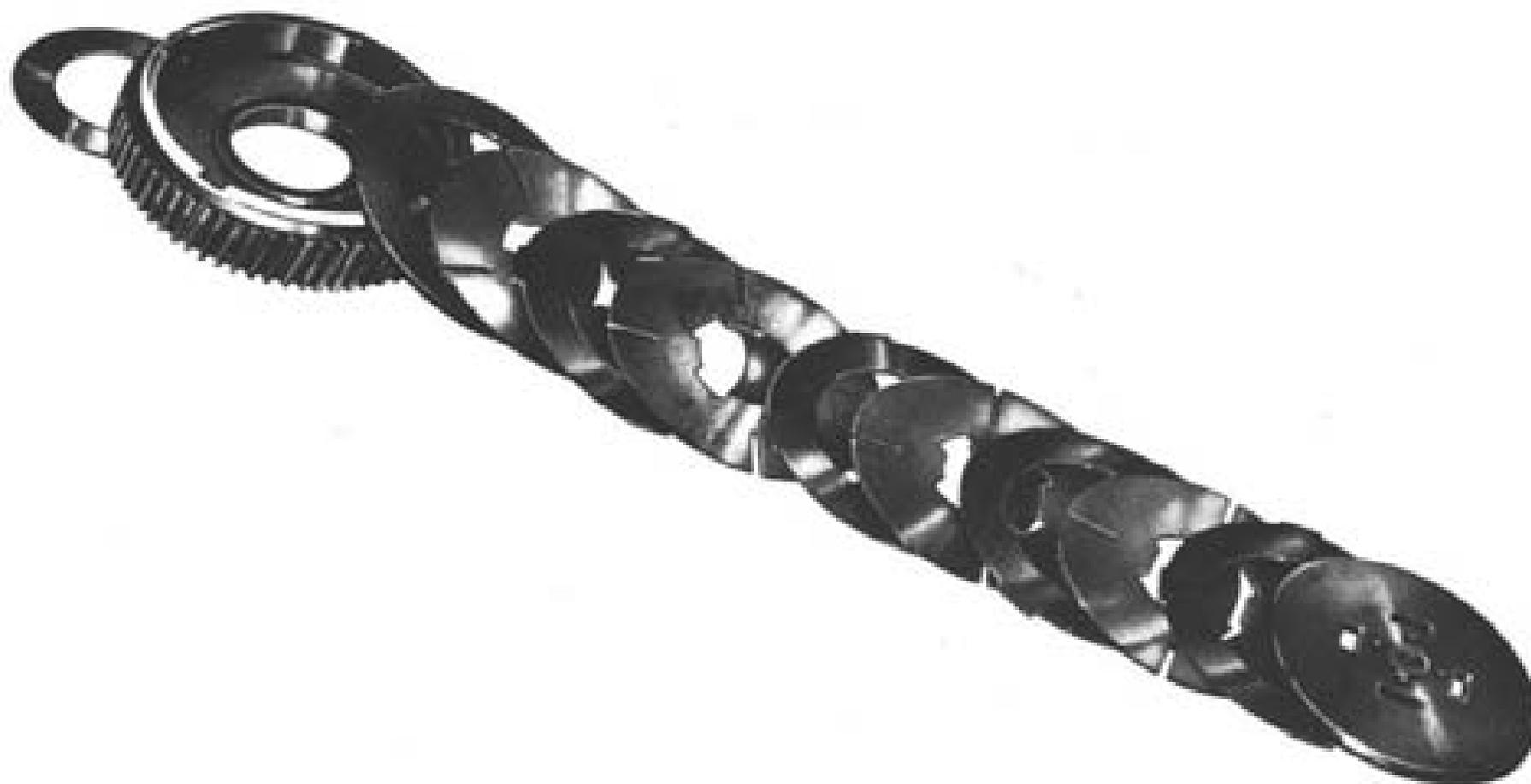
**Fig. 21 - Frizione smontata: osservare l'ordine di montaggio**
