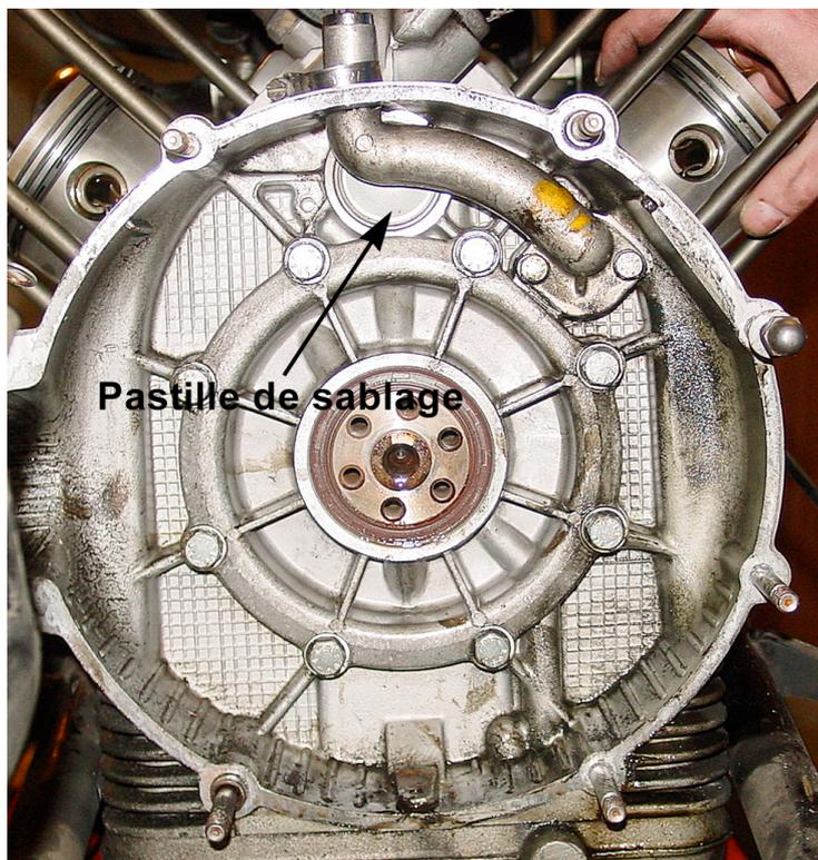
Le carter moteur des V-twins depuis la V7 sport a conservé à la base et en arrière du cylindre droit un gros trou (diamètre 30 mm, profondeur 20 mm) dont je ne comprends pas l'utilité, même sur les vieilles V7 / V7 spécial. Quelqu'un aurait une idée sur la question ?
