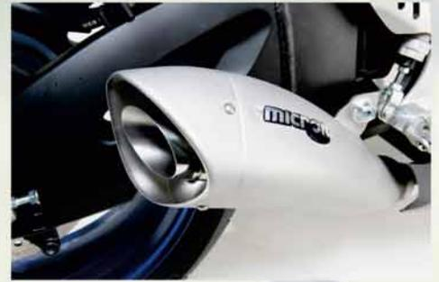
Les flasques arrière des silencieux Moto GP, en inox ultra-léger, se fixent directement sur l'enveloppe pour optimiser le poids.
