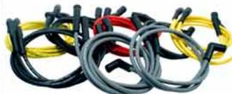
(1) : Avec un noyau de cuivre plein pour une utilisation sur des véhicules anciens (où l'interférence électrique n'est pas un problème), ou sur des véhicules
