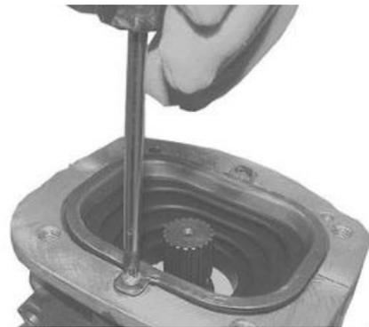
Die Öl-Einfüllschraube zusammen mit der Unterlegscheibe anbringen.
