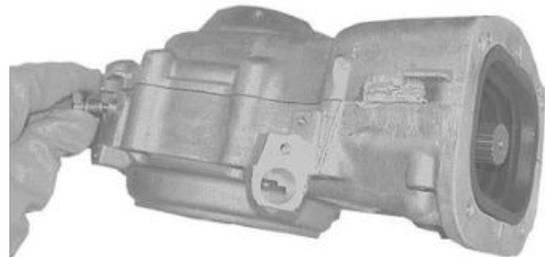
Die Öl-Ablassschraube zusammen mit der Unterlegscheibe anbringen.
