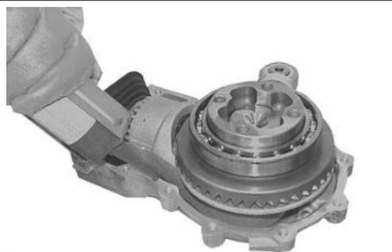
Einen neuen Dichtungsring mit dem Puffer einbauen.
