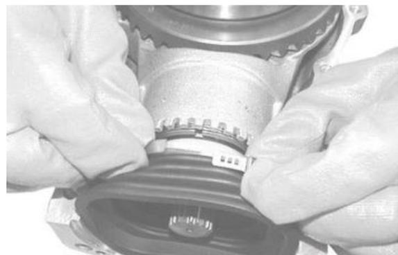
Die Schelle mit der entsprechenden Zange festziehen.
