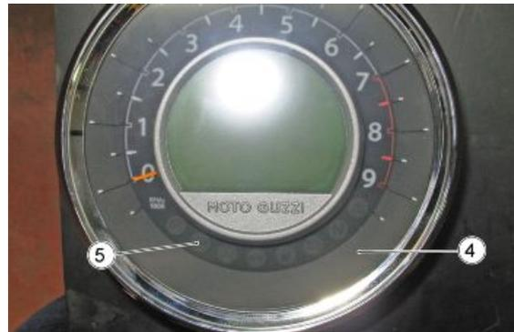
Wenn die ABS-Kontrolle auch während der Fahrt eingeschaltet bleibt, bedeutet das, es wurde eine Anomalie erfasst, und die ABS-Anlage ist automatisch deaktiviert worden.
