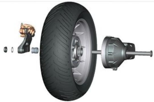
Beim Flansch vom Typ **B** muss die Verbindung zwischen Rad und Kardangelnk mit einer Dis-tanzscheibe unterbaut werden.
