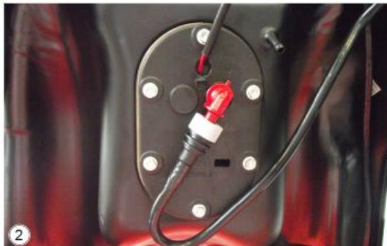
Der zweite Unterschied ist, wo die Entlüftungsleitungen verlaufen. Beim Modell "1" vereinen sich die beiden Leitungen in einem Y-Anschluss (siehe Bild). Beim Modell "2" hingegen verläuft die Leitung wie auf der zweiten Abbildung gezeigt.
