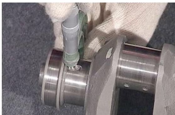
Die maximale Abweichung vom Parallelismus der beiden Achsen an der Kurbelwelle (Pleuelzapfen und Lagerzapfen Lichtmaschinen-seite und Seite Ventilsteuerung) darf, im Abstand von mm 40 (in 1.5748), nicht mehr als 0,02 (in 0.0009) betragen.
