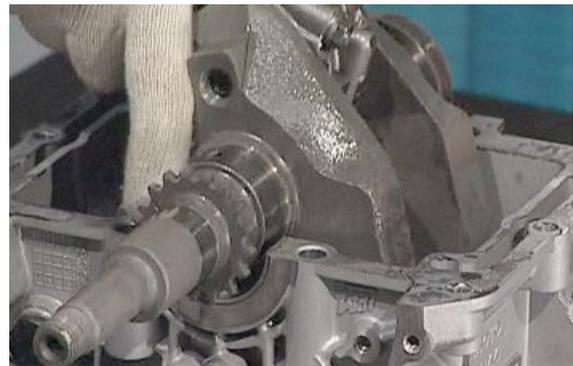
Den Öldrucksensor aus dem oberen Kurbelgehäuse abschrauben, die Sicherungsbuchse der Nockenwelle entfernen, anschließend die Nockenwelle und die Stößel herausziehen und nach Klassen markieren.
