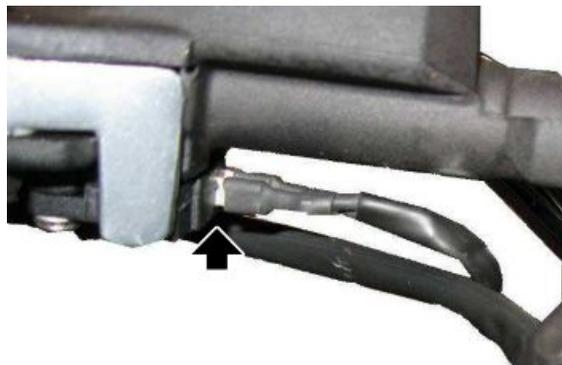
keine Spannung an PIN 26 am Kabelstecker
