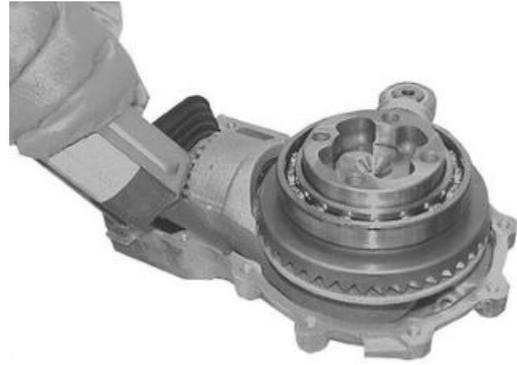
Einen neuen Dichtungsring mit dem Puffer einbauen.
