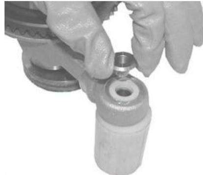
Die Dichtungsringe (2) und (7) mit einem Schraubenzieher entfernen.
