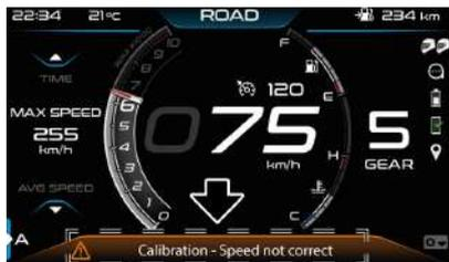
Zum Kalibrieren des MGCT-Systems (Moto Guzzi Controllo Trazione) ca. 10 Sekunden lang auf einem ebenen geraden Straßenabschnitt im zweiten Gang mit einer Geschwindigkeit von 40 +/- 2 km/h (24.85 +/- 1.24 mph) fahren, bis die Meldung "Calibration - Hold speed" auf dem Digitaldisplay erscheint.
