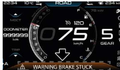
Falls der Druck länger als 60 Sekunden aufrechterhalten wird, während das Fahrzeug mit einer Geschwindigkeit von 10 km/h (6 mph) oder mehr fährt:
