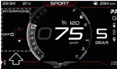
Zur Aktivierung der Funktion "VOICE CONTROL", die die Verwendung des Smartphone mit Spracheingaben über die Handsets gestattet (z. B. Siri oder Google-Assistant), diese zuerst mit den Tasten MODE UP oder MODE DOWN auswählen und dann kurz die Taste MODE SET drücken.
