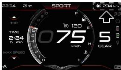
Wenn das Fahrzeug in die Reserve geht, verschwindet die verbleibende Reichweite, stattdessen werden zwei Striche (- -) angezeigt, und im Fahrtenbuch, das die in der Reserve zurückgelegte Strecke zählt, erscheint "TRIP FUEL". Dieser Wert wird jedes Mal zurückgesetzt, wenn der Benzinstand im Tank die Reserveschwelle überschreitet.
