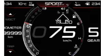
Falls aktiv, signalisiert diese Funktion das Vorhandensein von Hindernissen, die sich von links oder rechts hinter dem Fahrzeug nähern, durch Lichtsignale auf dem Display und dem entsprechenden Rückspiegel.
