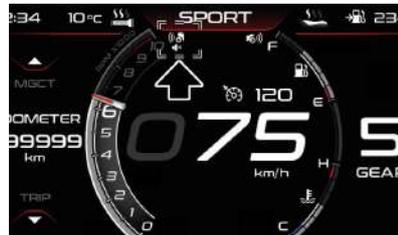
Wenn diese Funktion aktiviert ist, meldet sie das Vorhandensein von Hindernissen, die sich von der Fahrzeugfront her nähern, entweder von rechts oder von links, durch akustische Signale und Lichtsignale auf dem Display. Im Falle eines sich nähernden Objekts, bei dem die Gefahr eines Frontalzusammenstoßes besteht, gibt es zwei Warnstufen:
