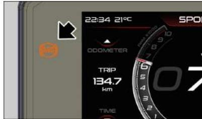
Wenn die ABS-Kontrollampe eingeschaltet bleibt oder weiter blinken sollte auch wenn 5 km/h (3.1 mph) erreicht wurden, bedeutet dies, dass eine Fehlfunktion festgestellt und das ABS deaktiviert wurde.
