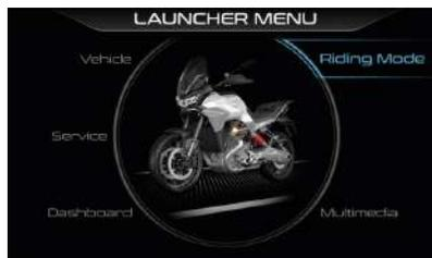
Mit der Taste MODE RIGHT den RIDING MODE auswählen, den Sie bearbeiten möchten, dann mit den Tasten MODE UP oder MODE DOWN das Element auswählen, das Sie bearbeiten möchten, und die Eingriffsstufe mit der Taste MODE RIGHT anpassen.
