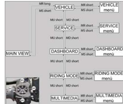
Das LAUNCHER MENÜ besteht aus den folgenden Punkten:
