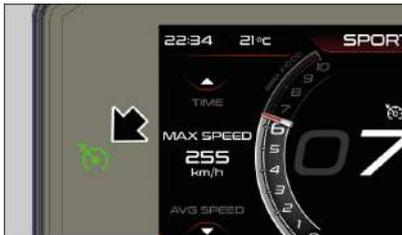
Nun kann der Gasgriff losgelassen werden, denn das System behält automatisch die gewählte Geschwindigkeit bei.
