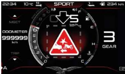
Bei einer Störung des Frontradars wird der Pop-up-Bereich des Armaturenbretts orange und die Meldung "Front Radar Disabled" mit dem Warndreieck an der Seite erscheint.
