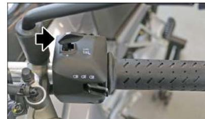
Mit den Steuertasten am linken Wechselschalter kann man die Systemseiten durchlaufen, die Informationen des Fahrtenbuchs A / B anzeigen und, falls das GMP-Steuergerät (Guzzi Multimedia Platform) vorhanden ist, auch die Informationen zu Telefon, Musik und Media Player einsehen.
