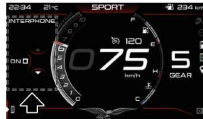
Ein weiterer kurzer Druck auf die Taste MODE SET deaktiviert die Verbindung und am Digitaldisplay wird der Status "INTERPHONE OFF" angezeigt.
