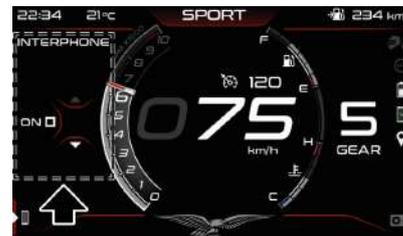
Anschließend kann die Wiedergabelautstärke durch längeres Drücken der Tasten MODE UP und MODE DOWN kontrolliert werden.
