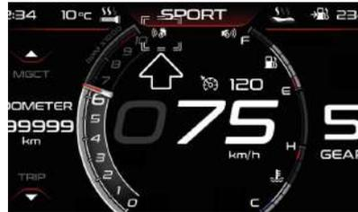
Radar aktiviert und Ton deaktiviert: Das Radarsymbol wird dem Symbol für deaktivierten Ton hinzugefügt.
