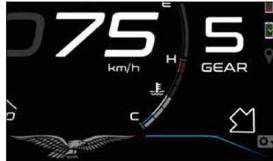
Das System verwendet das Signal des Gangschaltungssensors, der sich am Schalthebel befindet und führt so einen schnelleren Gangwechsel mit einer geringeren Drehzahlverringern aus als bei der herkömmlichen Gangschaltung bezüglich dem Schalten in einen höheren Gang.
