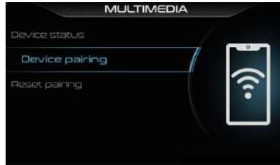
Nachdem die Funktion Bluetooth im zu verknüpfenden Gerät aktiviert wurde, erfolgt durch kurzes Drücken der Taste MODE RIGHT und Auswahl des Befehls "Devices pairing" aus dem Multimediamenü das Scannen der für das Pairing verfügbaren Geräte.
