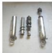
Zoom SRX 6, l'origine, modifié avec une vis de vidange.
