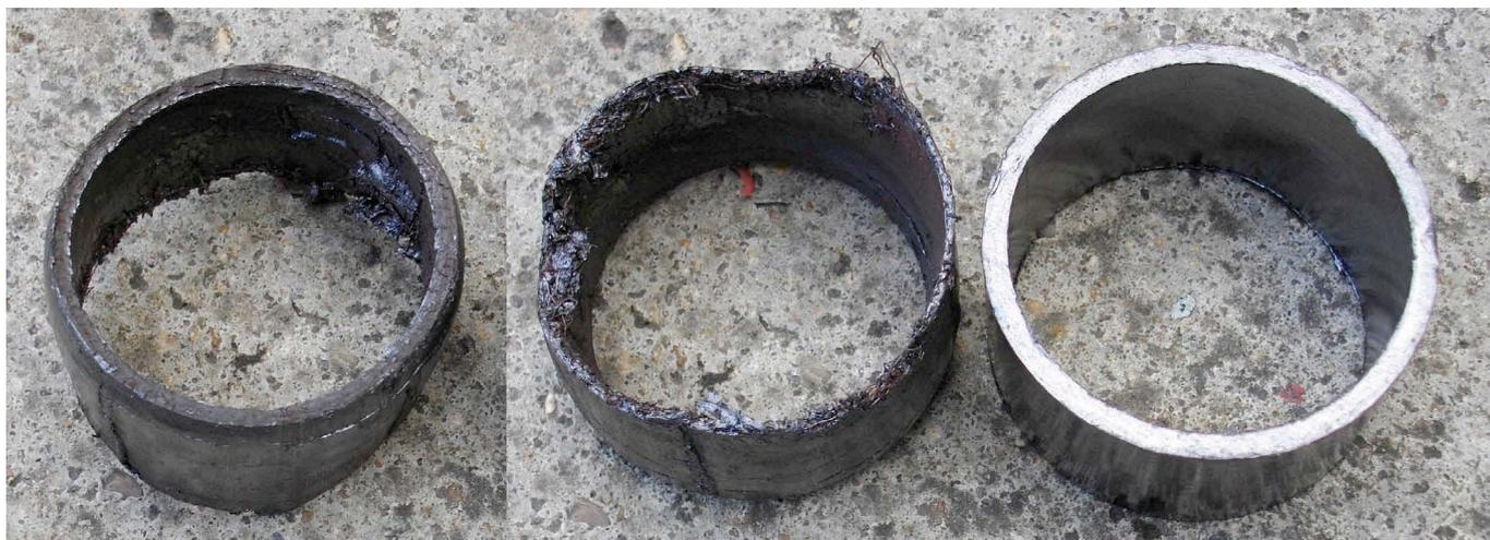
À gauche, les 2 cotés d'un joint graphité d'échappement et à droite, un joint neuf.
