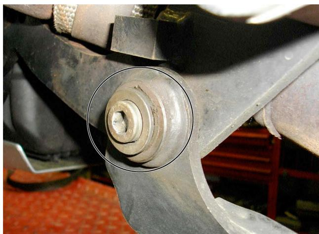
Par ailleurs, les vis de fixation des supports sont des M12x35 6 pans à tête bombée, empreinte de 8mm. Ces vis sont des daubes infâmes à remplacer systématiquement dès que possible si elles se desserrent, par des M12x35 CHC, empreinte de 10mm (cf plus loin).
