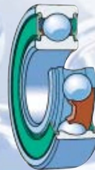
Schéma d'une coupe de roulement rigide à billes
