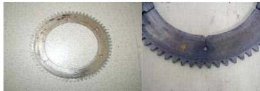
Die Bohrungen sind nur dazu da, dass der Sägeschnitt sauber endet. Bei Überarbeitung der Kupplung empfiehlt sich auch die gründliche Reinigung der Innenverzahnung ( ich glaube 102 Zähne ) der Schwungscheibe.
