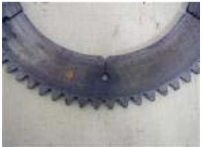
Les fentes permettent la compensation de la dilatation et les trous évitent qu'elles se prolongent par accident.
