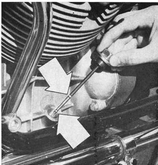
Après avoir revissé le bouchon d'un tour et retiré la jauge, le niveau doit se situer entre les deux repères indiqués par les flèches
