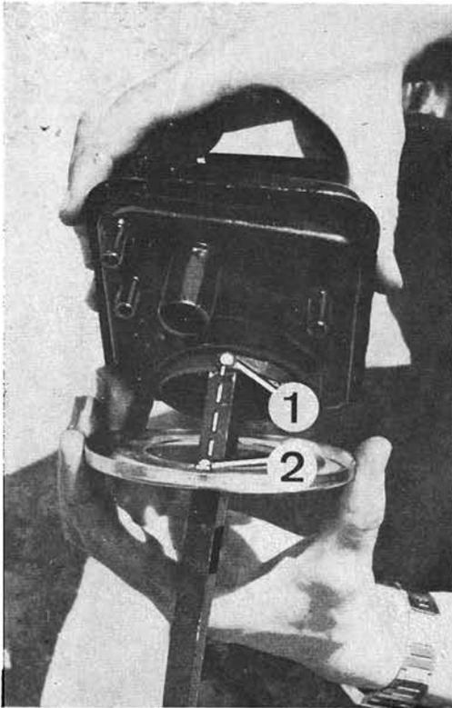
Au remontage du flasque sur le boîtier du filtre, faire correspondre le logement 1 avec le téton 2 (Photo RMT)
