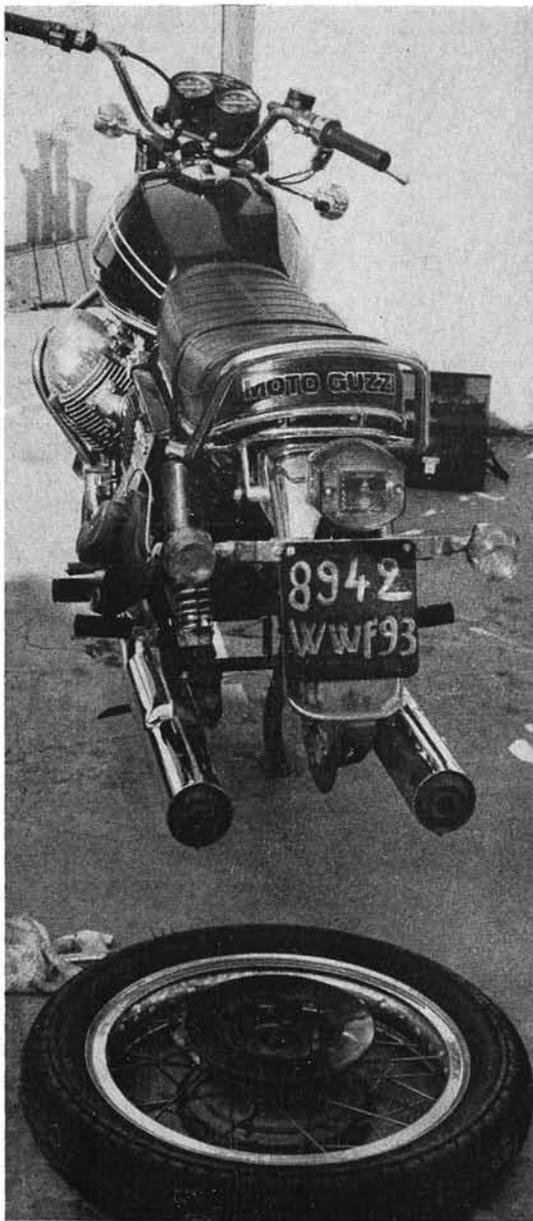
Démontage de la roue arrière (Photo RMT)
