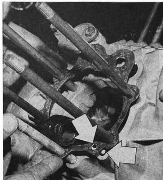
**Au remontage du joint d'embase, prendre soin de le positionner correctement afin de ne pas obstruer le passage d'huile (Photo RMT)**
