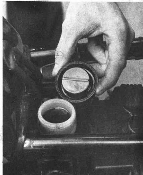
PHOTO 51 : Réservoir de liquide du maître-cylindre commandé par pédale, sur les modèles depuis 1981 (Photo RMT)
