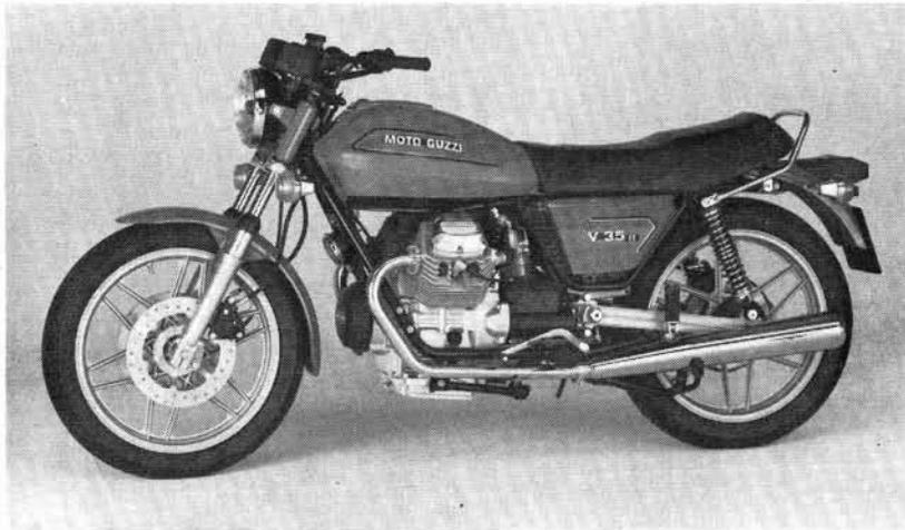
*La V 35 II a gagné quelques chevaux avec des carburateurs passant de 24 à 26 mm de diamètre*
