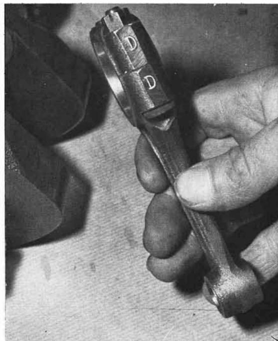
PHOTO 25 : Identification du poids des bielles par des lettres (Photo RMT)
