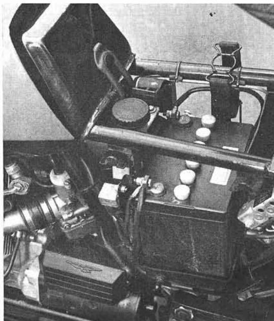
PHOTO 44 : Accès à la batterie (Photo RMT)
