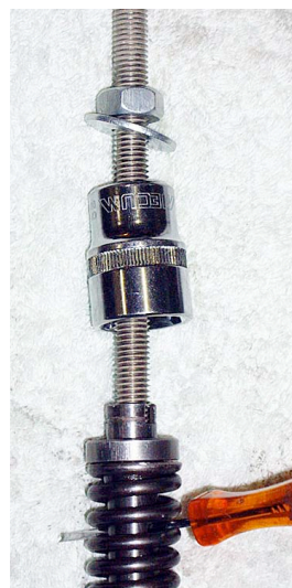
Dépose du dispositif de compression
