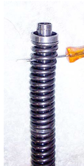
Il ne reste plus qu'à poser le circlip
