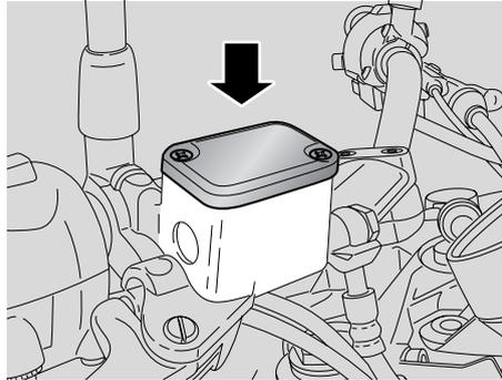
**IMPORTANT** Ce véhicule est équipé de freins à disque à deux systèmes de freinage avant et arrière, avec circuits hydrauliques séparés.
