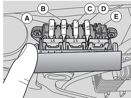
Contrôler avant les fusibles secondaires et successivement les fusibles principaux.
