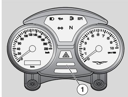
En appuyant sur le bouton TRIP (1), on obtient dans l'ordre les fonctions suivantes :
