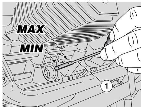
Si l'on effectue le contrôle du niveau de l'huile le moteur froid, l'huile pourrait descendre temporairement au-dessous du niveau "MIN".
